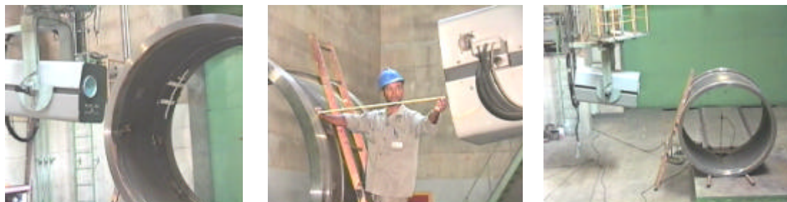
Fotos de um acelerador linear, usado para radiografia industrial de peças com espessura de 20 a 300 mm de aço.
